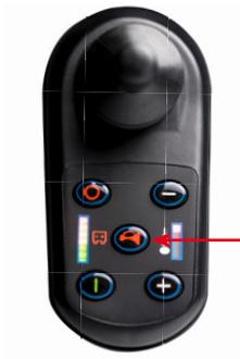
Abbildung 8: Taste „Hupe“ auf dem Bedienmodul“
