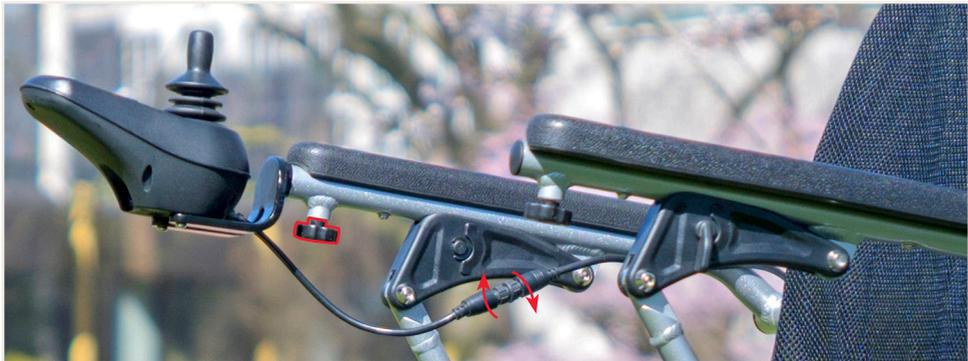
Abbildung 5: Das Bedienmodul fixieren und verbinden.
