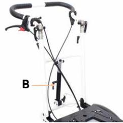
Für den leichteren Transport kann der Rücken nach vorne auf den Sitzrahmen abgeklappt werden. Hierzu den Knopf der Steckachse am unteren Ende der zentralen Schnellverstellung betätigen und die Steckachse herausziehen. Beim Zurückklappen die Schnellverstellung in die Aufnahme setzen und die Steckachse wieder montieren.
