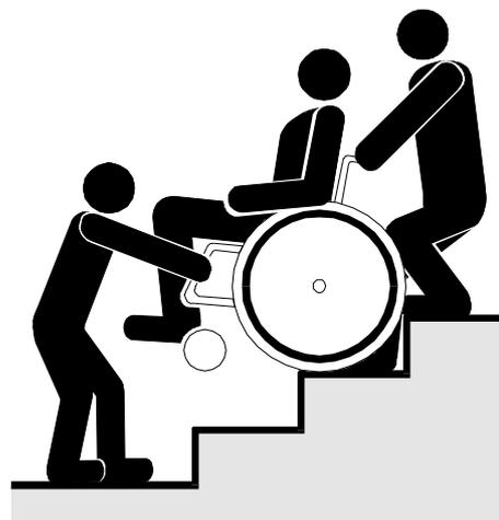
**Achtung:** Die Haltepunkte für den Transport des Fahrgestells CRUISER sind ausschließlich der Rahmen und die Schiebegriffe. Überprüfen Sie bitte, daß der Handbogen am Rücken und die Klemmhebel der Höhenverstellung fest montiert sind!
