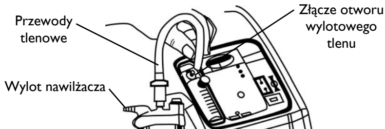
RYSUNEK 5.4 Podłączanie przewodów tlenowych
