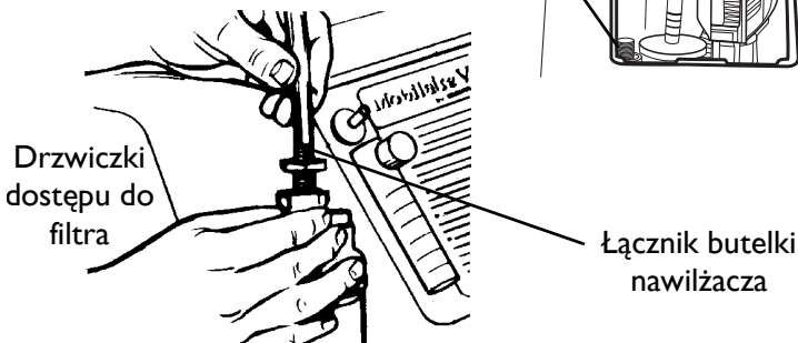
RYSUNEK 5.3 Podłączanie łącznika butelki nawilzacza
