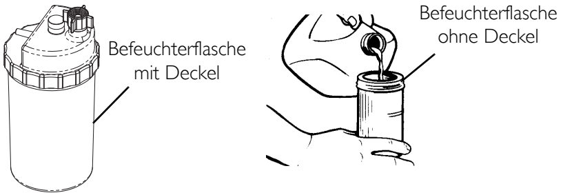
ABBILDUNG 6.1 Auffüllen des Befeuchters
