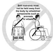
**! Achten Sie darauf, dass das Gurtband nicht verdreht ist und dass der Gurtverschluss und sein Auslöseknopf so positioniert sind, dass sie bei einem Aufprall nicht mit Rollstuhlteilen in Berührung kommen.**
