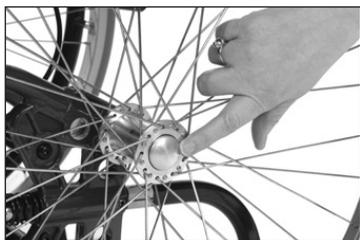
**!** Um zu kontrollieren, ob das Antriebsrad korrekt eingerastet ist, lassen Sie den Entriegelungsknopf los und ziehen das Antriebsrad leicht nach außen.
