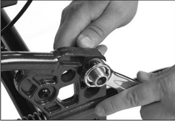
Achten Sie darauf, dass die Mutter an der Innenseite des Rahmens die Radbuchse komplett umschließt.
