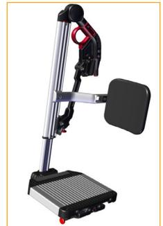
Sie ist schwenkbar und abnehmbar. Die Beinstütze wird mit höhen- und tiefenverstellbarer Wadenplatte geliefert. Die Fußplatten lassen sich hochklappen und auf unterschiedliche Winkel einstellen. Standardmäßig werden die Fußplatten mit einer Arretierung geliefert, die die 2 Platten miteinander verbindet und die Platten stabiler macht und den Wartungsaufwand reduziert. Wenn eine Arretierung nicht gewünscht ist, kann der Bolzen mit einem Inbusschlüssel entfernt werden.
