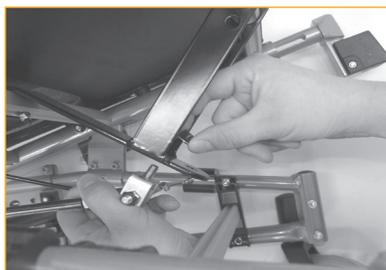
Für jede Position wird das Rückenlehnscharnier herausgezogen, die Gasdruckfeder wird um ein Loch nach hinten verschoben. Wenn die Gasdruckfeder die hinterste Bohrung mit kurzem Verriegelungskopf erreicht hat, wechseln Sie auf langen Verriegelungskopf und beginnen Sie wieder mit dem vorderen Loch.
