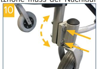
**Schrauben nach Einstellung unbedingt fest anziehen und den sicheren Halt überprüfen!**
