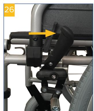
Pour faciliter le transfert dans et hors du fauteuil roulant le levier du frein de stationnement peut être rabattu (**fig. 27 + 28**). Pour cela, tirer le levier du frein vers le haut puis le rabattre.
