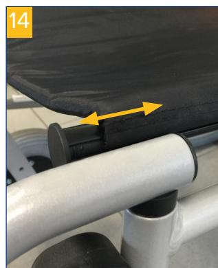
Il est alors possible de tirer le châssis vers l'avant jusqu'au trou suivant (en tout 3 fois) avant de remettre les vis.
