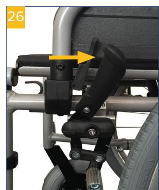
Per rendere più comodo il trasferimento sulla e dalla carrozzella, la leva di azionamento del freno di stazionamento può essere ribaltata (**fig. 27+28**). Per farlo, tirare la leva verso l'alto e ribalzarla.
