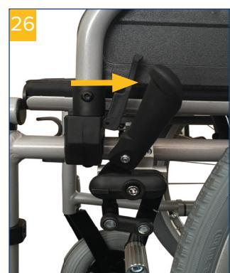
Voor een gemakkelijke transfer uit en in de rolstoel kan de bedieningshendel van de parkeerrem worden omgeklapt. (**afb. 27+28**). Trek hiervoor de hendel naar boven en klap hem daarna om.
