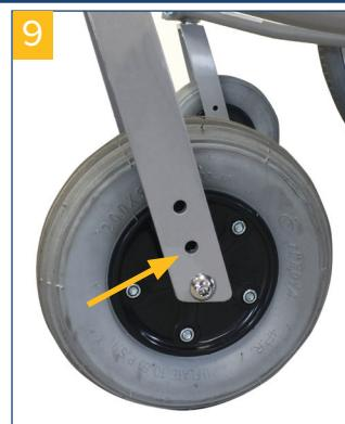
I tappi dei relativi fori sono facilmente intercambiabili. Portare la ruota nella posizione desiderata e installare di nuovo la vite, stringendo a fondo (**fig. 9**).
