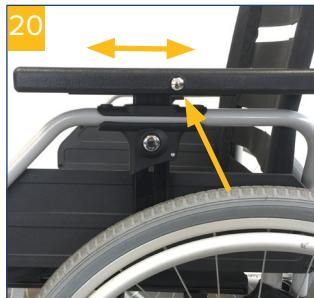
Pour régler la longueur, appuyer sur le bouton à ressort au milieu à l'extérieur du repose-bras et faire coulisser ce dernier dans la position souhaitée (fig. 21).
