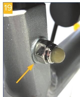
Stecken Sie die Schrauben wieder ein und setzen Sie die Griffmuttern auf und ziehen diese fest an.
