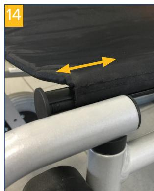
Nun können Sie den Rahmen bis zur nächsten Bohrung (insgesamt drei mal) nach vorne ziehen und die Schrauben wieder einsetzen.
