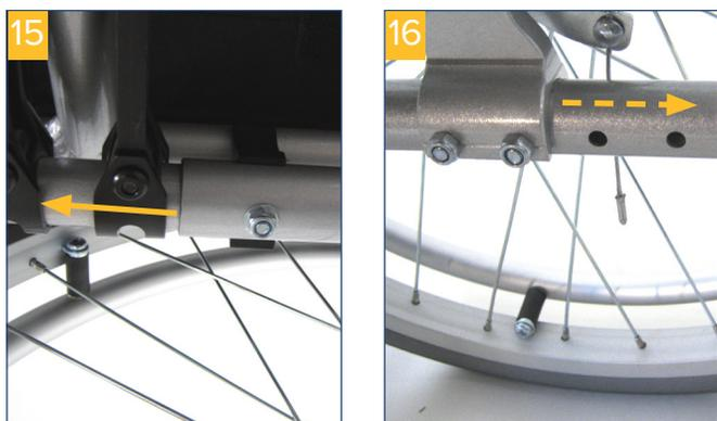
Ora è possibile tirare in avanti il telaio fino al foro successivo (tre volte in tutto) e reinserire le viti.
