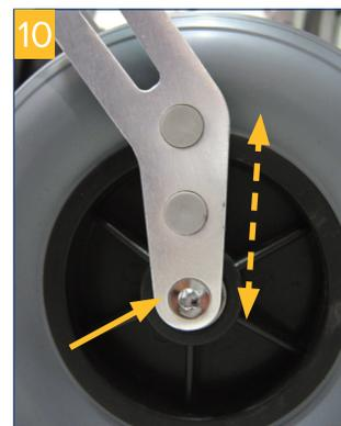
De afsluitingen van de verschillende openingen zijn gemakkelijk te verwisselen. Zet het wiel nu in de gewenste positie, breng de schroef van de wielas weer aan en draai deze vast (afbeelding 10).
