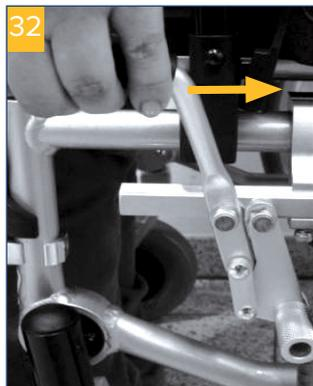
**Verificare sempre che il freno di stazionamento sia bloccato provando a muovere la carrozzella.**
