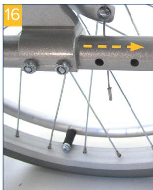
Il est alors possible de tirer le châssis vers l'avant jusqu'au trou suivant (en tout 3 fois) avant de replacer les vis.
