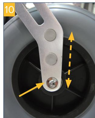
Les bouchons des trous sont facilement interchangeables. Placer la roue dans la position souhaitée, replacer la vis de l'axe de roue et la resserrer (fig. 10).
