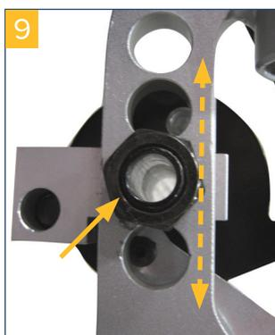
Replacer l'écrou avec sa rondelle d'arrêt et le resserrer (fig. 9).
