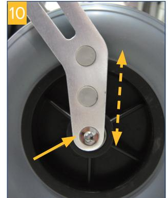
Die Stopfen der entsprechenden Bohrungen sind leicht austauschbar. Versetzen Sie das Rad nun in die gewünschte Position und stecken Sie die Radachsenschraube wieder ein und ziehen diese fest (**Bild 10**).
