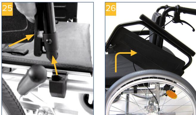
Möchten Sie die Armstützen komplett abnehmen, so entriegeln Sie sie vorne wie zuvor beschrieben und heben Sie diese etwas an, so dass sie frei ist.
