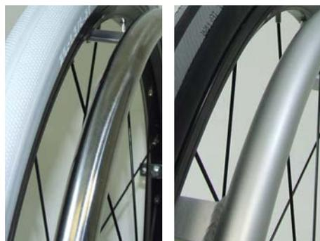
Es können Greifreifen mit einem Standarddurchmesser oder mit einem größeren Durchmesser angebaut werden.
