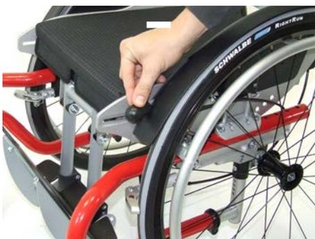
Drücken Sie zum Schließen der Bremse den Bremshebel mit den Fingern oder dem Handballen nach unten.
