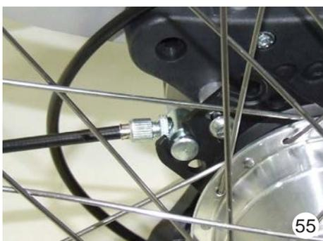
Die Bremskraft kann durch Herausdrehen der Stellschraube verstärkt werden.
