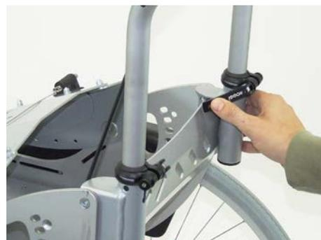
Die Schließkraft des Exzenterhebel kann durch Verstellen der Rändelmutter bei geöffnetem Hebel eingestellt werden (17).
