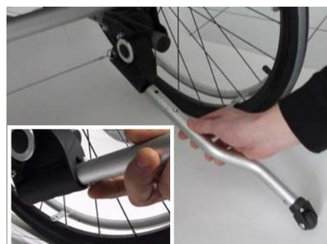
Der Rollstuhl ist mit zwei Kippschutzeinheiten ausgerüstet. Die Abbildung (9) zeigt den Kippschutz in der „aktiven“ Position.
