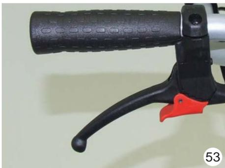
Jede Trommelbremse wird mit jeweils einem Bremsgriff bedient.
