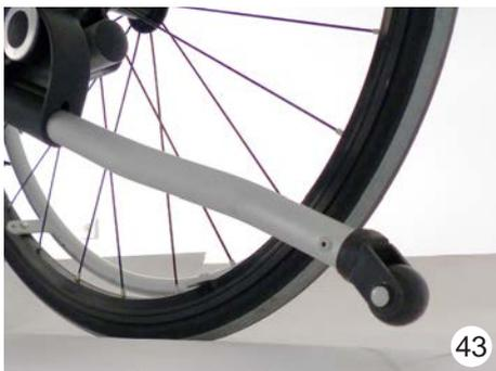
Der Kippschutz wird so eingestellt, dass die Rolle am Ende des Kippschutzrohres über den Radius des Antriebsrades hinausragt und ca. 2-3 cm über dem Boden steht.
