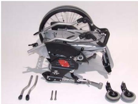
Jedoch besteht auch die Möglichkeit den Rollstuhl mit wenigen Handgriffen in ein paar kleinere Packstücke zu zerlegen.
