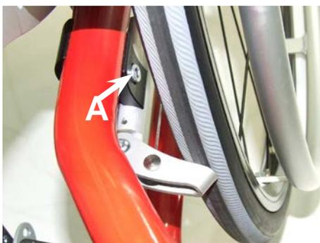
Der Bremsbügel drückt auf den Reifen und hält diesen fest. Dabei steht der Bremsbügel im 90° Winkel zum Halter. Der Bremsbügel soll ca. 3-5 mm über die Radmitte hinausstehen.
