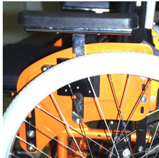
Die Seitenteile sind am Rahmen des Rollstuhls fest verschraubt und sind nicht abnehmbar.
