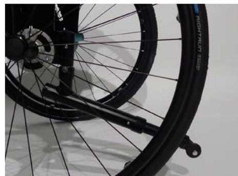
Nach Drücken der Stativfeder kann die Länge des Kippschutzrohres in der Kippschutzaufnahme in drei Positionen (mit jeweils 2,5 cm Abstand) eingestellt werden.
