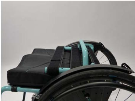
Wenn Ihr **CESA** mit dem **winkelverstellbarem Rücken** ausgestattet ist, kann es sein, dass er für den Transport abgeklappt ist.
