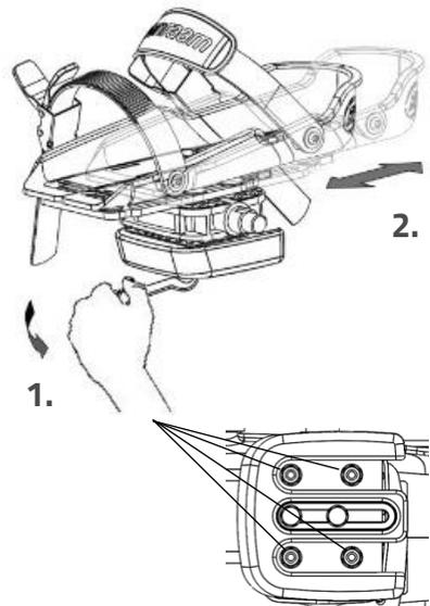
Die Fußschale ist auch der Breite nach einstellbar. Dabei kann nur die äußere Hälfte der Fußschale nach außen geschoben werden.
