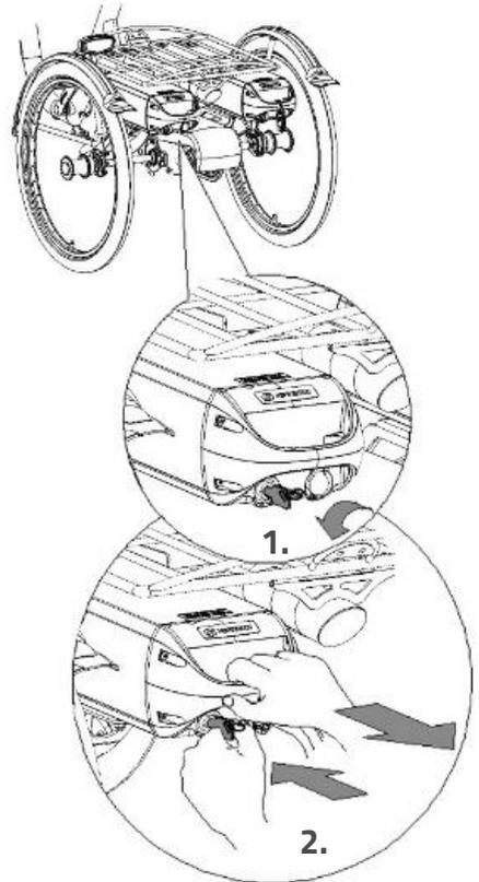
4. Stecken Sie **dann** den Ladeanschluss des Kabels in den Ladepunkt des Akkus. Die rote LED leuchtet auf. Das Ladegerät ist nun am Aufladen.
