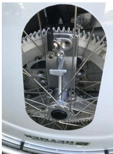
Bild 3 Hebel im Schiebetrieb, Hebel zeigt nach außen (auf)
