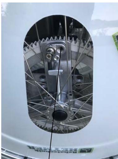
Bild 2 Hebel im Fahrbetrieb, Hebel zeigt zur Radmitte (zu)
