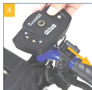
**Nota:** Il display - posto all'interno o all'esterno - può essere applicato sulla manopola destra o sinistra, a seconda di quale sia la posizione più comoda per l'utilizzatore.
