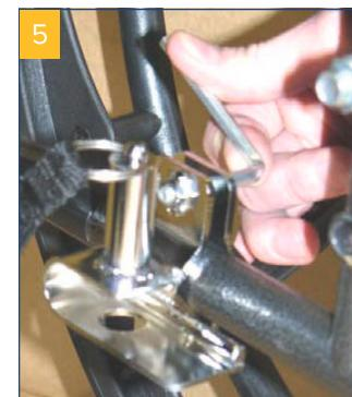
Centrer ensuite le PowerStroll et le fixer solidement au moyen des vis à ailettes. Le PowerStroll doit être en position horizontale sur le fauteuil roulant. S'il ne l'est pas, corriger la position du moteur au moyen du système de réglage de la hauteur sur le PowerStroll (**fig. 6**).
