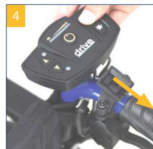
**Opmerking:** Het display kan aan de binnen- of buitenkant op de linker- of rechterduwgreep worden aangebracht, afhankelijk van wat prettiger is voor de gebruiker.
