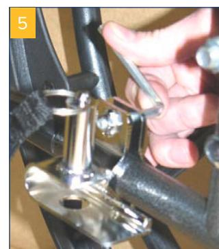
Richt de PowerStroll daarna in het midden uit en maak deze stevig vast met de vleugelbouten. Wanneer de PowerStroll op de rolstoel is gemonteerd, moet deze horizontaal staan. Is dat niet het geval, dan corrigeert u de aandrijving met de hoogteverstelling op de PowerStroll. (**afb. 6**).
