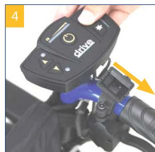
**N.B. :** La commande manuelle peut être montée sur la poignée gauche ou droite – vers l'intérieur ou vers l'extérieur – selon la disposition la plus agréable pour l'utilisateur.
