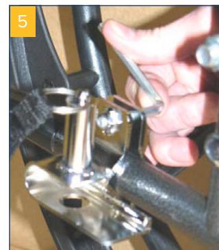
Danach den PowerStroll mittig ausrichten und mit den Flügelschrauben fest fixieren. Wenn der PowerStroll am Rollstuhl angebaut ist sollte dieser in einer waagrechten Position stehen. Falls dies nicht der Fall sein sollte, dann mittels der Höhenverstellung am PowerStroll den Antrieb ausrichten (**Bild 6**).
