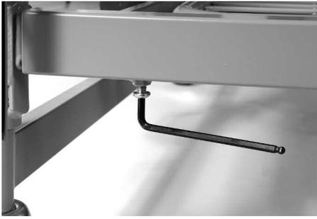
☞ Schrauben Sie die 4 Stück Inbusschrauben mit einem Inbusschlüssel gut fest.
